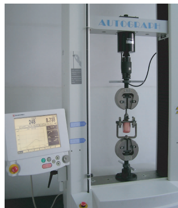
图1 椎弓根螺钉拔出实验
