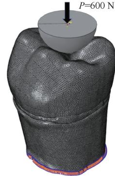
图3 模型的载荷施加及边界条件设定
