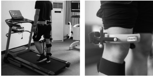
图1 实验场地仪器示意图与跟踪器固定方式
