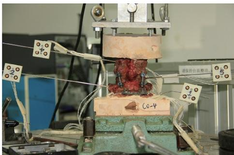
图 3 枕骨、C1~3 椎上连接的克氏针和红外线标尺
