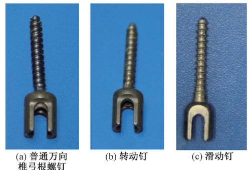
图1 实验中使用的螺钉
