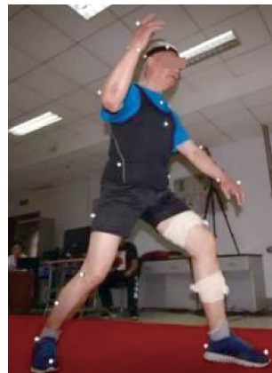
图1 红外反光球粘贴位置
