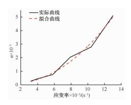
图 6 参数 a-应变率曲线与拟合结果比较
