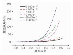
图 4 弹道明胶高应变率下的真实应力-应变曲线
