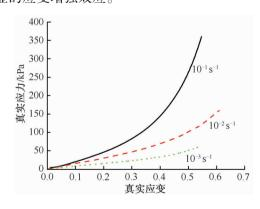
图 1 弹道明胶不同应变率下的准静态真实应力-应变曲线
