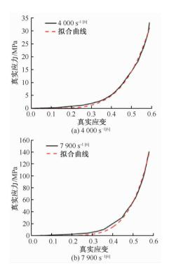
图 5 两种不同应变率下真实应力-应变曲线与拟合结果比较
