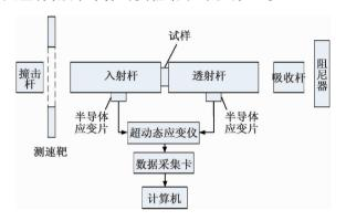
图 2 分离式霍普金森压杆试验简图
