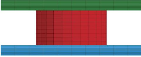
图1 应变率为  $260 \text{ s}^{-1}$  时脂肪组织压缩试验的有限元重构
