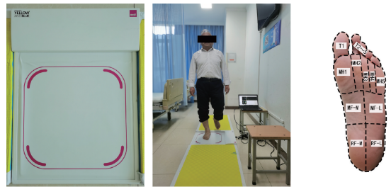
图2 足底压力测试 (a) 足底压力测试平板 (b) 足底压力测试过程 (c) 足底区域划分
