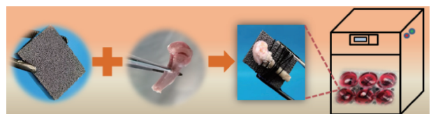
图1 骨组织-钛珠涂层材料结合试样
